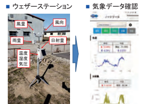
図 3 KOSEN 版ウェザーステーションとデータ確認
