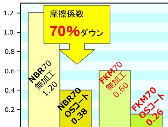
※当社試験では平均摩擦係数が約70%ダウンする事が実証されました。(ロードセル式試験)
