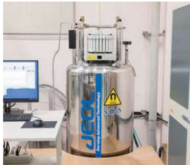
500 MHz (溶液) 小金井キャンパス ECA500 (日本電子) ^1\text{H} , ^{13}\text{C} , 多核 ( ^{15}\text{N} , ^{29}\text{Si} , ^{11}\text{B} , ^7\text{Li} , ^{31}\text{P} , ^{19}\text{F} など) 勾配磁場 (最大90 G/cm) 長時間VT (-10°C~室温)
