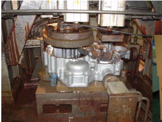
エンジン部品・空圧検査用ジグ
